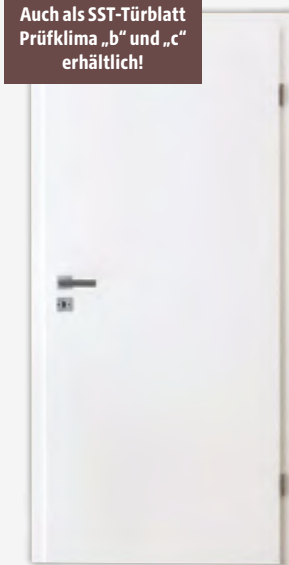
Schallschutz-Türblatt (SST), Weisslack mit Eckkante (EC), Schallschutz (Rwp 32dB), Prüfklima „c“ inkl. Bodendichtung 3-tlg. Bänder, vern., PZ-vorgerichtet
