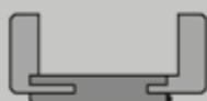
Zarge mit Schließblech in Weiß, Verstellbereich -8/+10 mm, Designkante, Futterplatte mit kl. Rundkante (60 mm)
